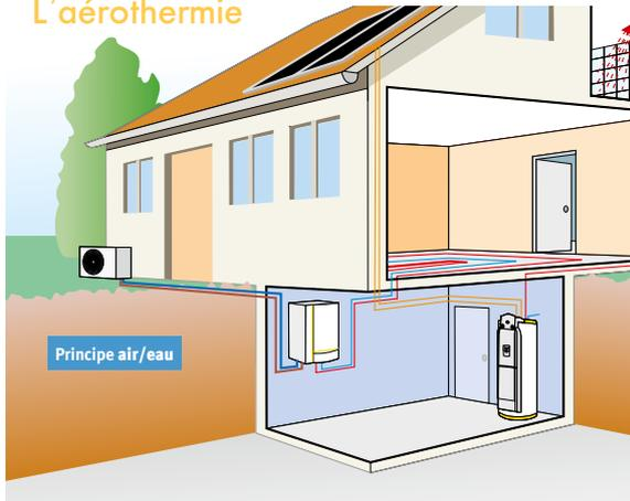
L'aérothermie consiste à capter les calories dans l'air extérieur grâce à une pompe à chaleur.
