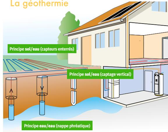
La géothermie puise la chaleur présente dans le sol à travers des capteurs verticaux ou horizontaux, selon la configuration du terrain.
